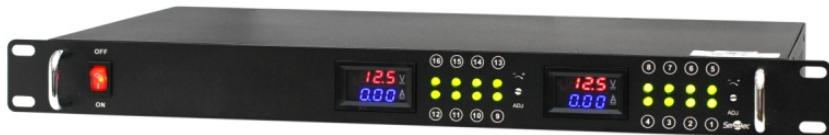
Профессиональный блок питания ST-PS120RM-BK предназначен для высококачественного электропитания напряжением 12 В постоянного тока оборудования видеонаблюдения и других устройств без необходимости резервирования питания. Индивидуальная защита для каждого выходного канала с помощью самовосстанавливающихся предохранителей обеспечивает независимость питания подключаемых устройств.
