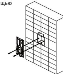
4 Закрепите устройство на монтажной пластине с помощью винта, поставляемого в комплекте (SC-KM3X6-T10-SUSS).
