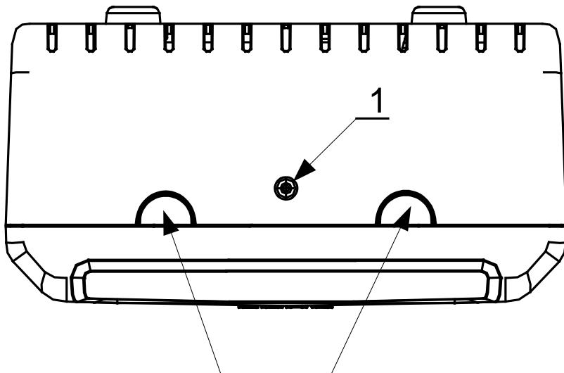
Нажать на выемки основания корпуса для открытия крышки
